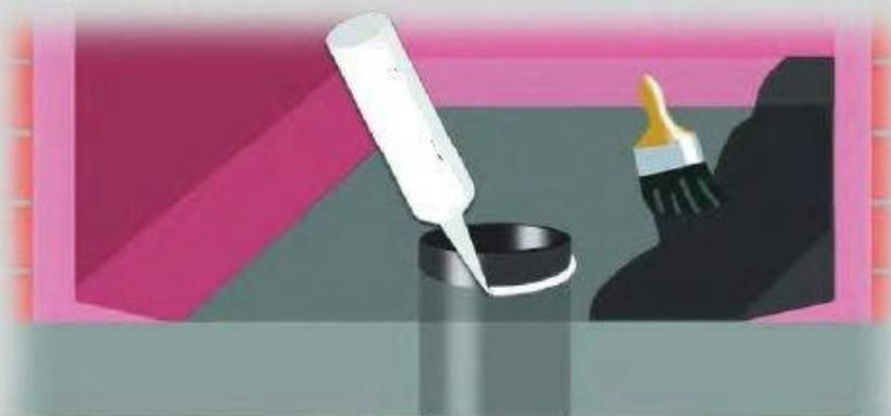
Applicare del silicone nel settore pavimento almeno 24 ore prima tra le tubature di acqua e il pavimento prima dell'utilizzo di IZONIL.
