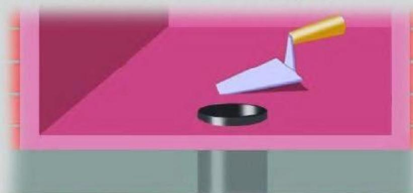
Sulla miscela fresca di acqua/cemento, applicazione di IZONIL COARSE dello spessore di 20 mm.
