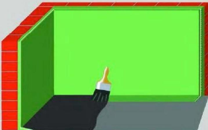
Prima dell'applicazione dello strato IZONIL COARSE applicare una miscela con proporzione cemento / acqua = 1: 1,5
