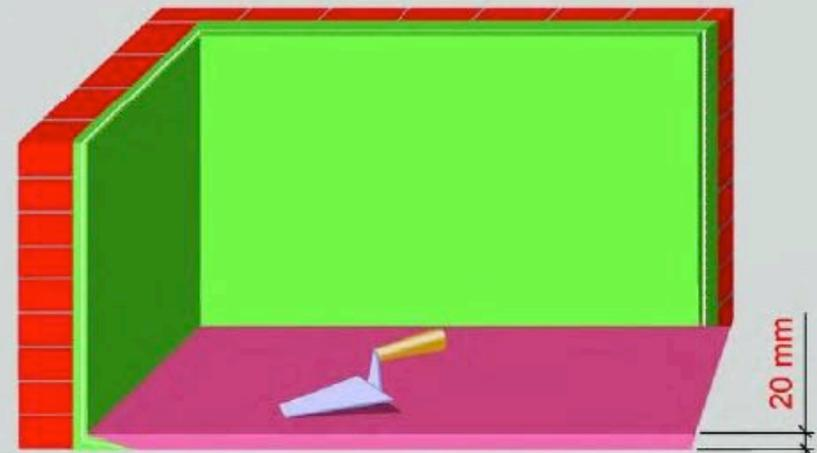
Auf dem frischen Zement-Wasser.Gemisch die IZONIL Hart-Schicht in einer Stärke von 20 mm auftragen.
