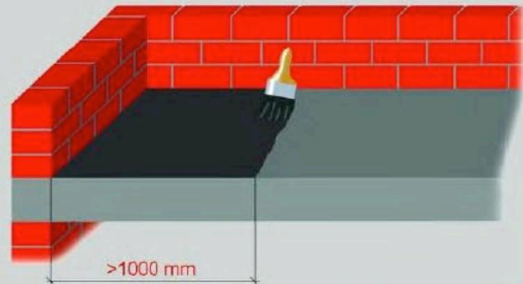
Auf der nassen Dachfläche eine Mischung von Wasser und Zement in einer Breite von ca. 1 m auftragen. Mischverhältnis Zement / Wasser 1:1,5
