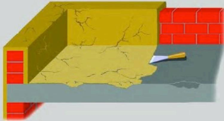
Loses Material, Staub und jegliche Verunreinigungen entfernen. Die Flächen müssen frei sein von Fett, Säuren oder anderen wasserabweisenden Stoffen.
