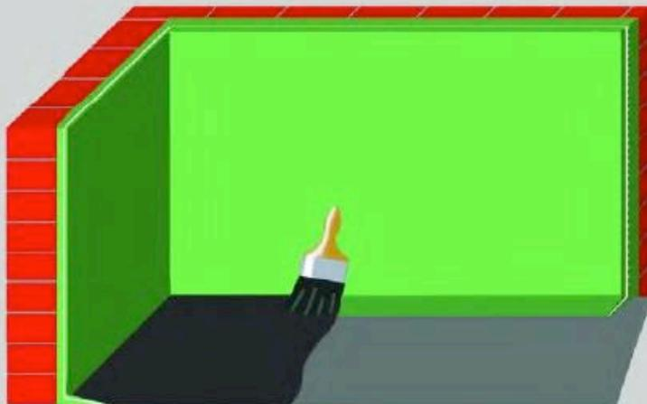
Vor dem Auftragen der IZONIL Hart-Schicht ein Zement-Wassergemisch auftragen.
