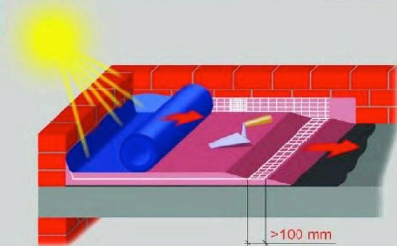
Bei starker Sonneneinstrahlung und windigem Wetter wird die IZONIL-Oberfläche mit einer Plastikfolie abgedeckt. Die Folie schützt vor zu schneller Trocknung.
