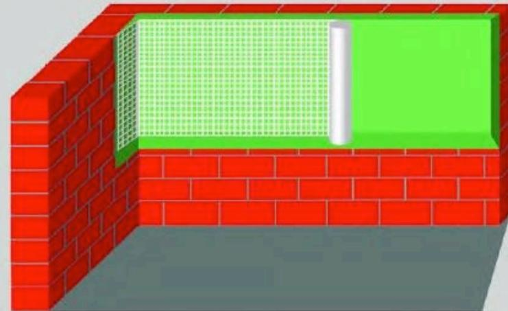
Auf die frische Schicht das Glasfasernetz anbringen und sofort die zweite Schicht in einer Stärke von 5 mm auftragen.
