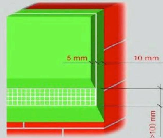
Während dem Auftragen der zweiten IZONILschicht ist es wichtig, ca. 100 mm des Glasfasernetzes freizulassen. Dieser Bereich wird für den Übergang der Folgenden IZONILschicht benötigt.
