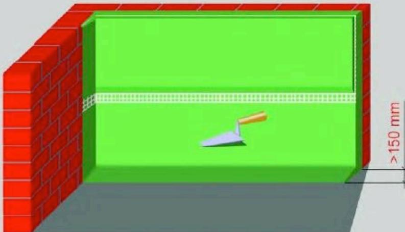
Auftragen der ersten IZONILschicht im unteren Bereich in einer Stärke 10 mm. Mindestens 100 mm des Glasfasernetzes freilassen.
