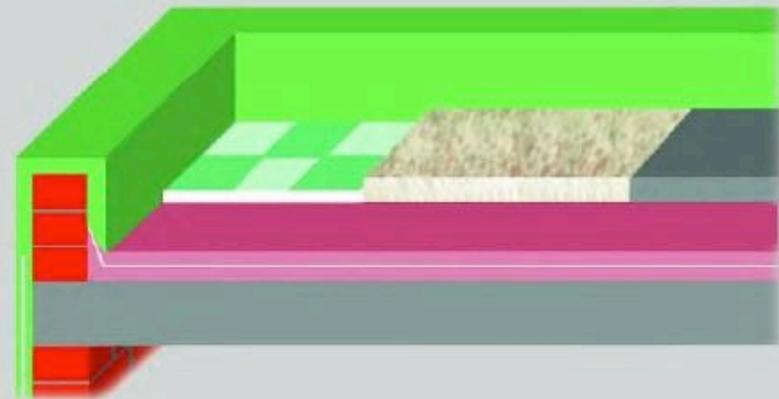
Es wird empfohlen die Oberfläche von IZONIL mit Fliesen oder Kies vor etwaigen Beschädigungen zu schützen.
