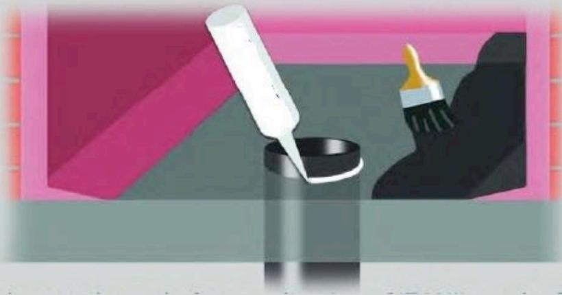
Mindestens 24 Stunden vor der Anwendung von IZONIL im Bodenbereich Silikon zwischen Wasserrohr und Boden anbringen. Nach dem Aushärten des Silikons ein Zement-Wasser-Gemisch auftragen. Mischverhältnis Zement / Wasser 1:1,5
