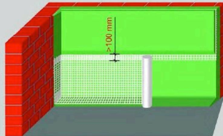
Auf die frische IZONILschicht das Glasfasernetz anbringen und sofort die zweite Schicht in einer Stärke von 5 mm auftragen. Übergang der Glasfasernetze ca. 100 mm.
