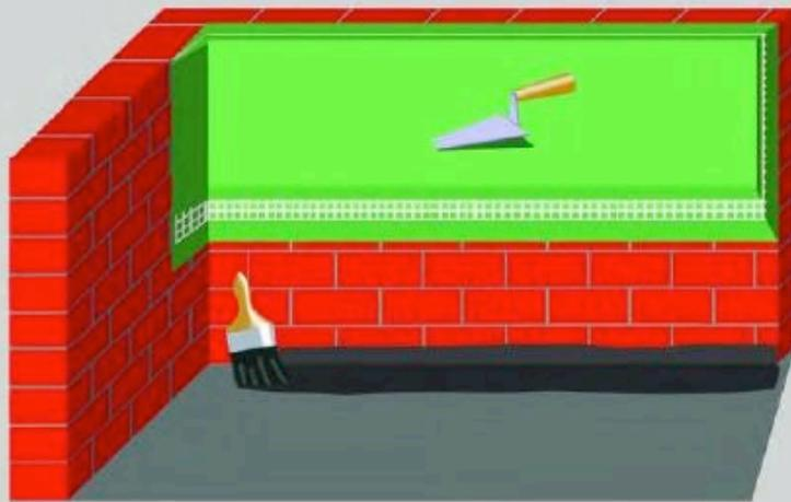
Vor dem Auftragen der unteren IZONILschicht zwischen Wand und Boden im Eckbereich ein Zement-Wasser-Gemisch auftragen. Mischverhältnis Zement / Wasser 1:1,5
