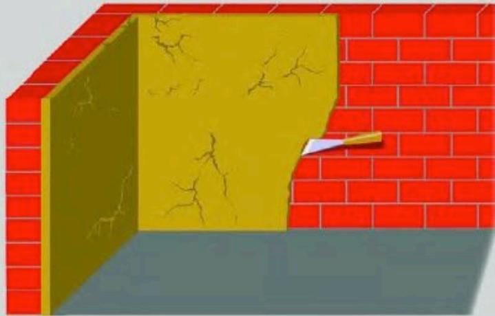
Loses Material, Staub und jegliche Verunreinigungen entfernen. Die Flächen müssen frei sein von Fett, Säuren oder anderen wasserabweisenden Stoffen.
