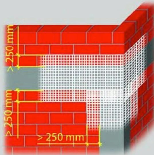
Um Rissen vorzubeugen sind alle Verbindungen von unterschiedlichen Materialien ( Ziegel, Beton ) mit Glasfasernetzen zu verstärken.
