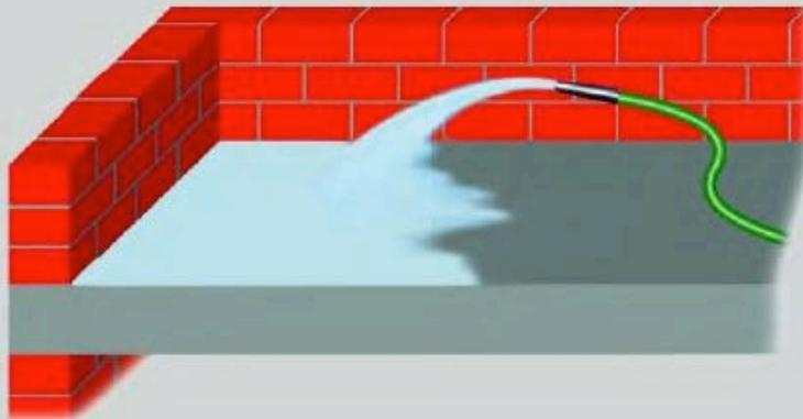
Die Dachfläche befeuchten. Die Oberfläche muss vor dem Auftragen von IZONIL nass sein.
