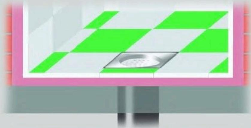
Nach dem Aushärten der Silikonschicht die Rohrabdeckung fixieren. Für die Isolierung von Rohren in Wänden die gleiche Vorgehensweise verwenden.
