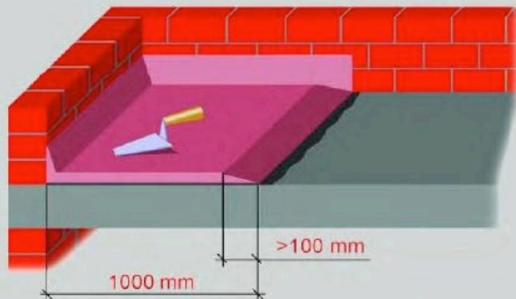
Erste IZONIL-Schicht in einer Stärke von 10 mm auftragen, maximale Breite 1100 mm. Für die bessere Anwendung des Glasfasernetzes die Breite von 1100 mm nicht überschreiten.
