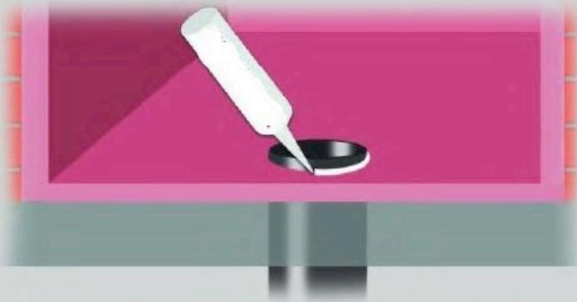
Nach dem Aushärten der IZONIL-Schicht Silikon zwischen Wasserrohr und IZONIL-Schicht anbringen.
