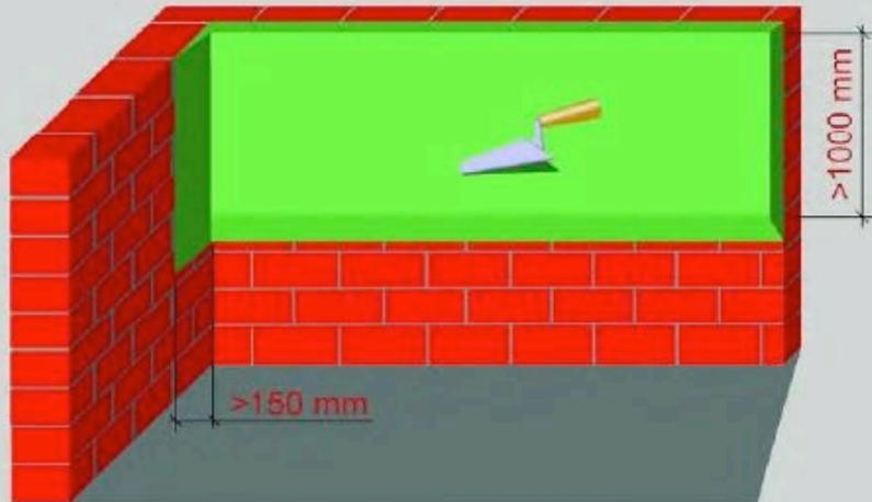
Die erste IZONIL-Schicht in einer Stärke von 10 mm auftragen. Nicht mehr als 4 m<sup>2</sup> bedecken.
