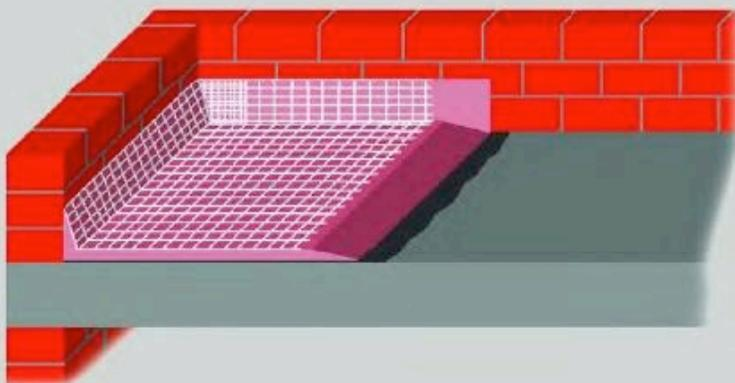
In die frische IZONIL-Schicht das Glasfasernetz einlegen und sofort die zweite Schicht IZONIL in der Stärke von 10 mm auftragen.
